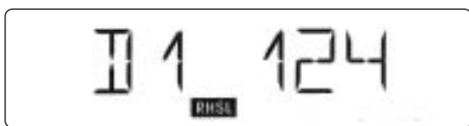
Ejemplo 1: Dropout Nr. 1 después de 124 segundos.
