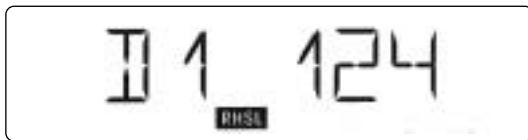
Exemple 1 : dropout N° 1 après 124 secondes.
