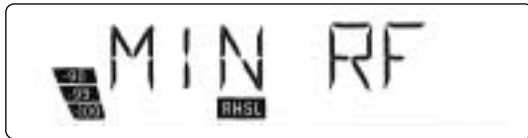
Esempio 2: Livello RF minimo -90 dB.
