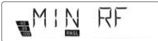
Exemple 2 : niveau HF minimum de -90 dB.
